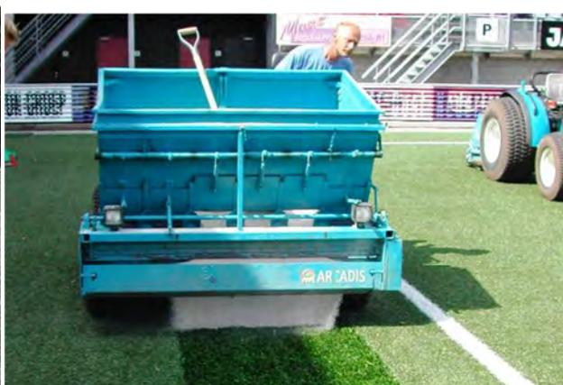
Application du matériau de remplissage avec des machines à l'origine pas prévues pour ce travail...
