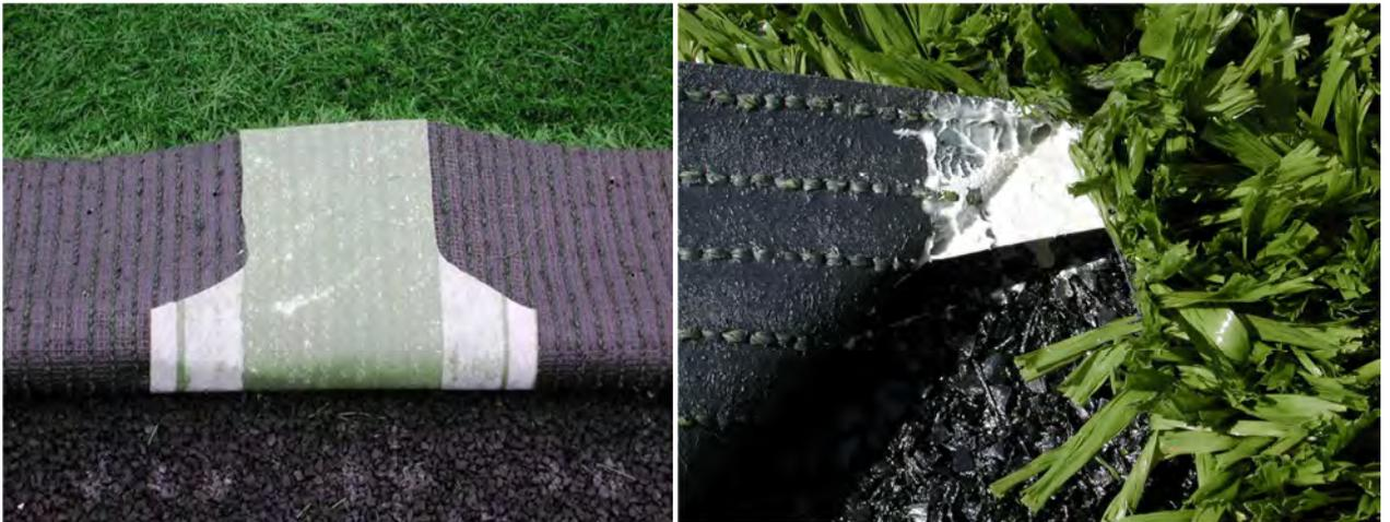
Contrôle de la solidité des joints qui maintiennent ensemble les rouleaux et les lignes de marquage
