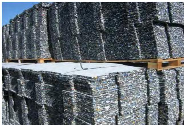
**Sous-couches préfabriquées sous forme de rouleaux et sous forme de plaques**
