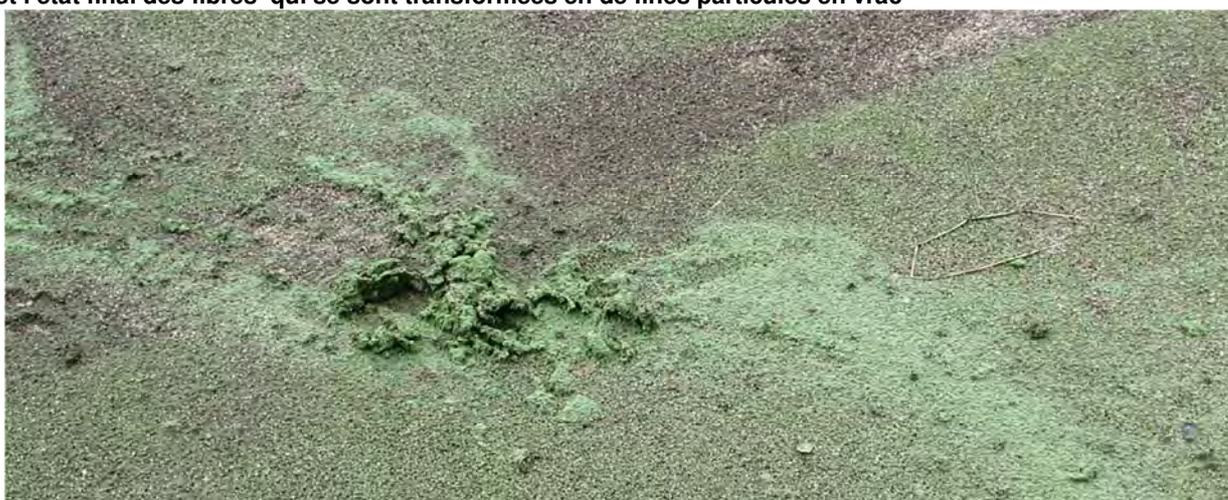
**Note :** Des fibres non traitées contre les UV peuvent perdre leur résistance. Les signes visibles sont : perte de couleur ou perte accrue de résistance = augmentation de la cassure des fibres (augmentation de la fragilité des fibres). Un test d'exposition aux UV/A de 400 heures représente 5 ans d'exposition du Football Turf en Europe et seulement 2 ans aux Caraïbes.
