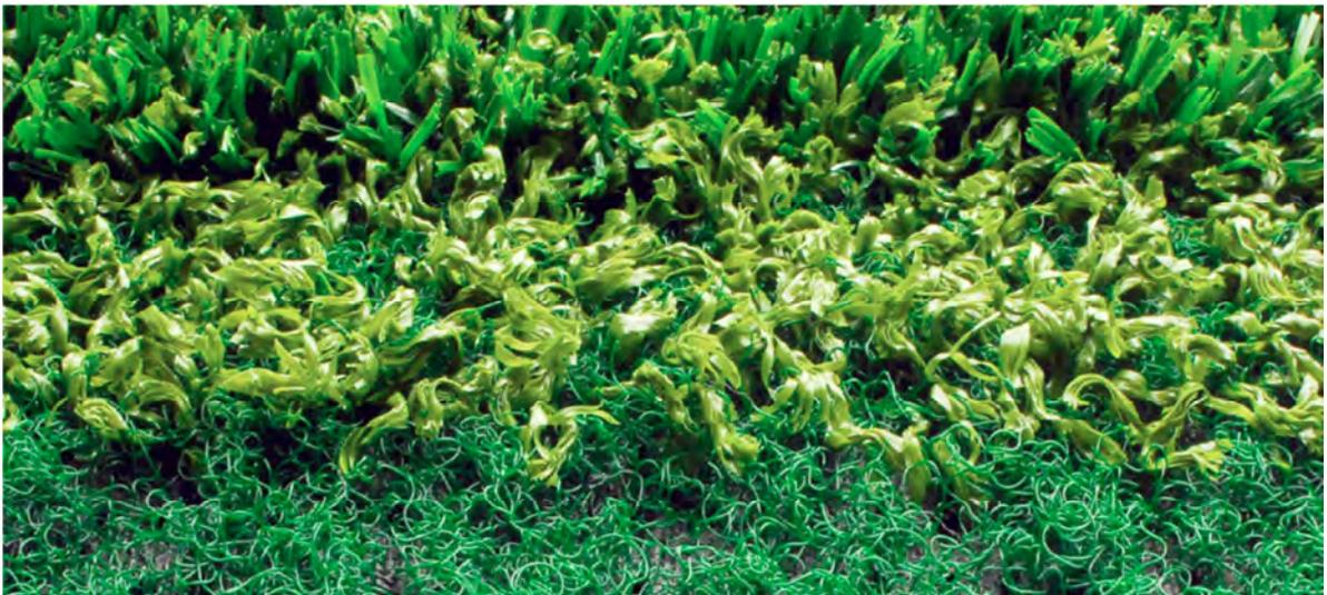
**Exemple de Football Turf sans remplissage, composé de différentes qualités de fibres dans le même produit dont la densité des petits fibres doit remplacer le remplissage**
