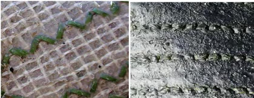
Différents types de support de Football Turf et méthodes de fixation des fibres dans le support.
