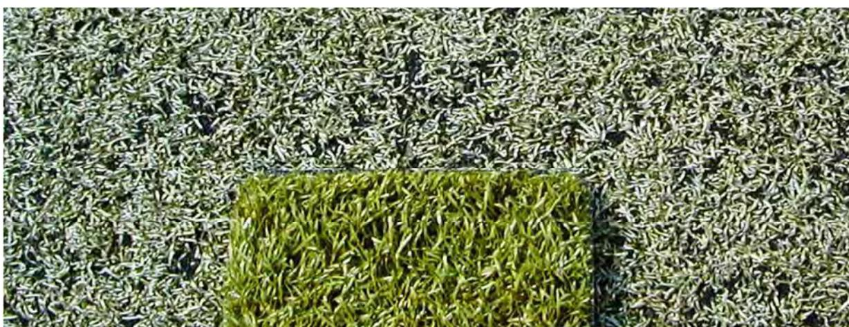
Fibres non résistantes aux UV : état d'un Football Turf après 2 ans comparé au gazon original et l'état final des fibres qui se sont transformées en de fines particules en vrac
