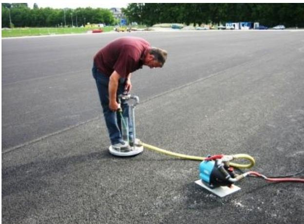
**Contrôle de la perméabilité du béton bitumineux**
