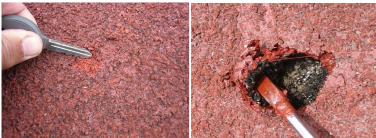
Le produit en polyuréthane est constitué initialement de deux composants. Lors de la construction, les deux composants sont mélangés et appliqués sur le béton bitumineux. Sous l'action climatique (les rayons UV, chaud et froid, sec et humide), ou par un défaut de fabrication, les molécules sont en train de se désolidariser et redeviennent liquides.
